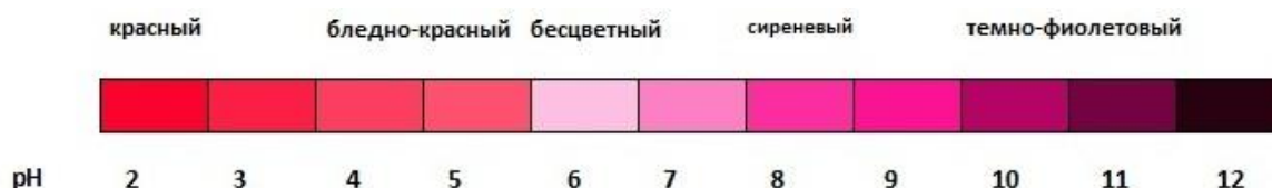
Рис. 8. Изменение окраски экстракта гибискуса в зависимости от различных значений pH
