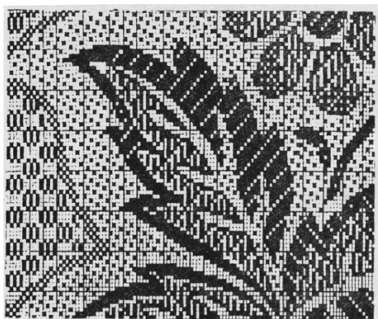
Рис.38. Часть рисунка крупноузорчатого переплетения
