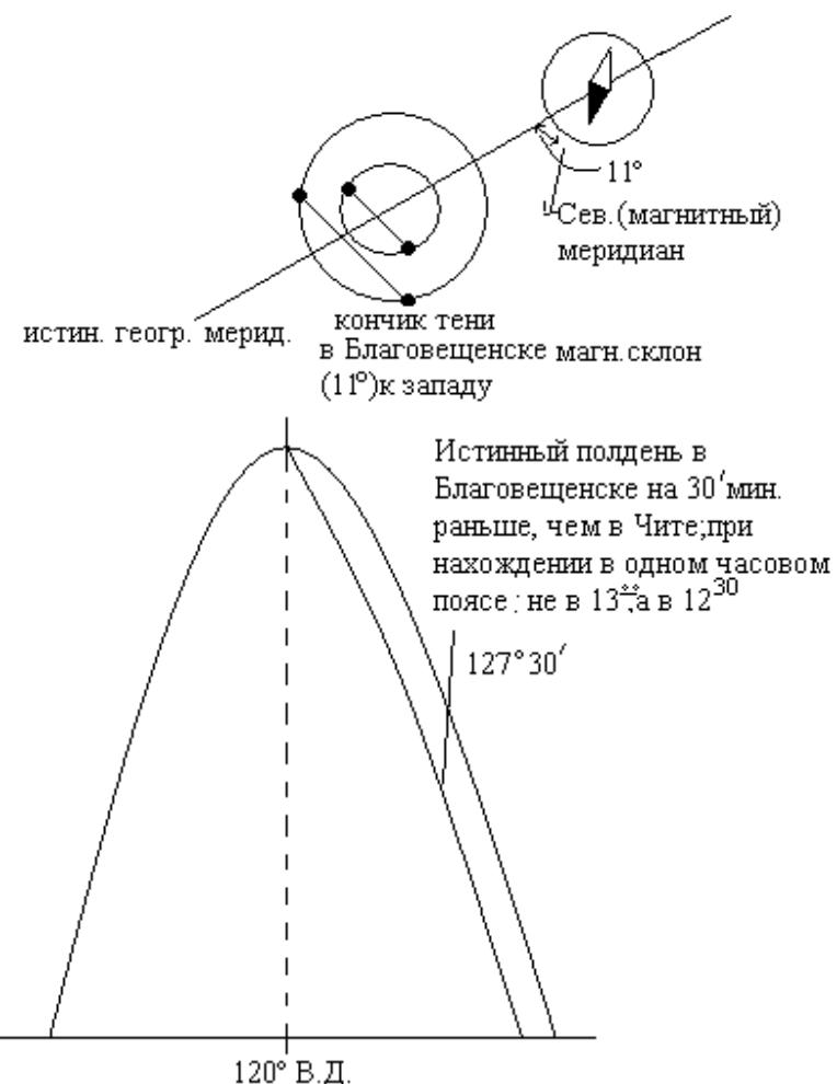
*Определение истинного меридиана по полярной звезде*
