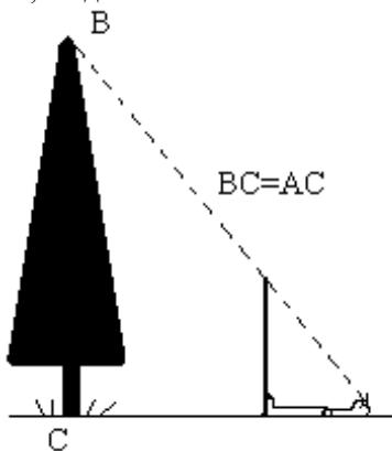
**По треугольнику** (с двумя углами по  $45^\circ$ )
