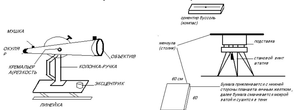
**Кипрегель автомат (КА-2).** Автомат означает, что превышения определяются автоматически и высвечиваются в окуляре.
