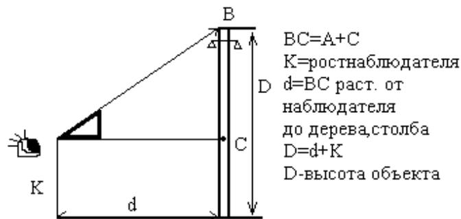
**Определение расстояний на глаз.** Надо знать высоту объекта, до которого измеряем расстояние. Пример: рост человека около 1,6-1,8м., труба Благовещенской ТЭЦ-190м., 5-этажного здания 15-18м., столб ЛЭП деревянный-6м.
