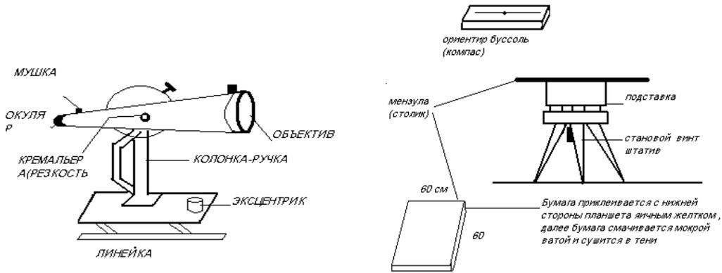
**Кипрегель автомат (КА-2).** Автомат означает, что превышения определяются автоматически и высвечиваются в окуляр.
