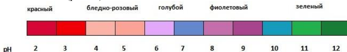
Рис.13. Изменение окраски экстракта краснокочанной капусты в зависимости от различных значений pH
