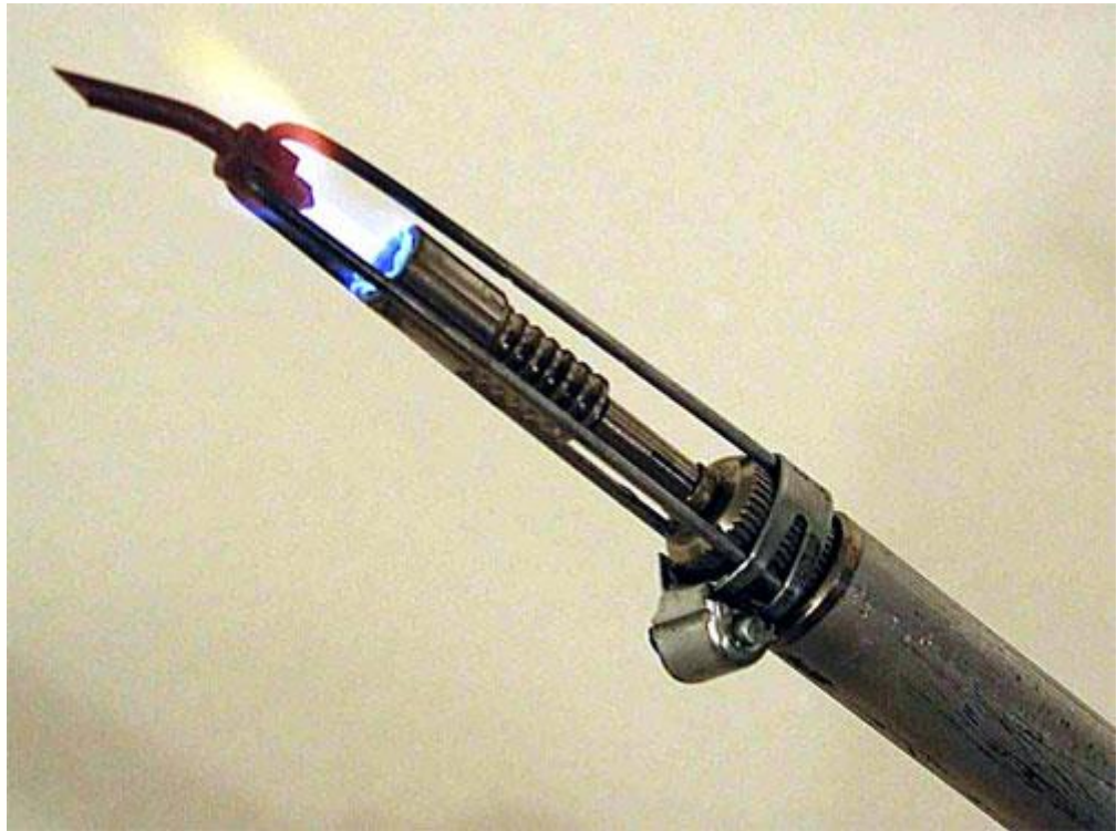
Самодельный газовый паяльник
