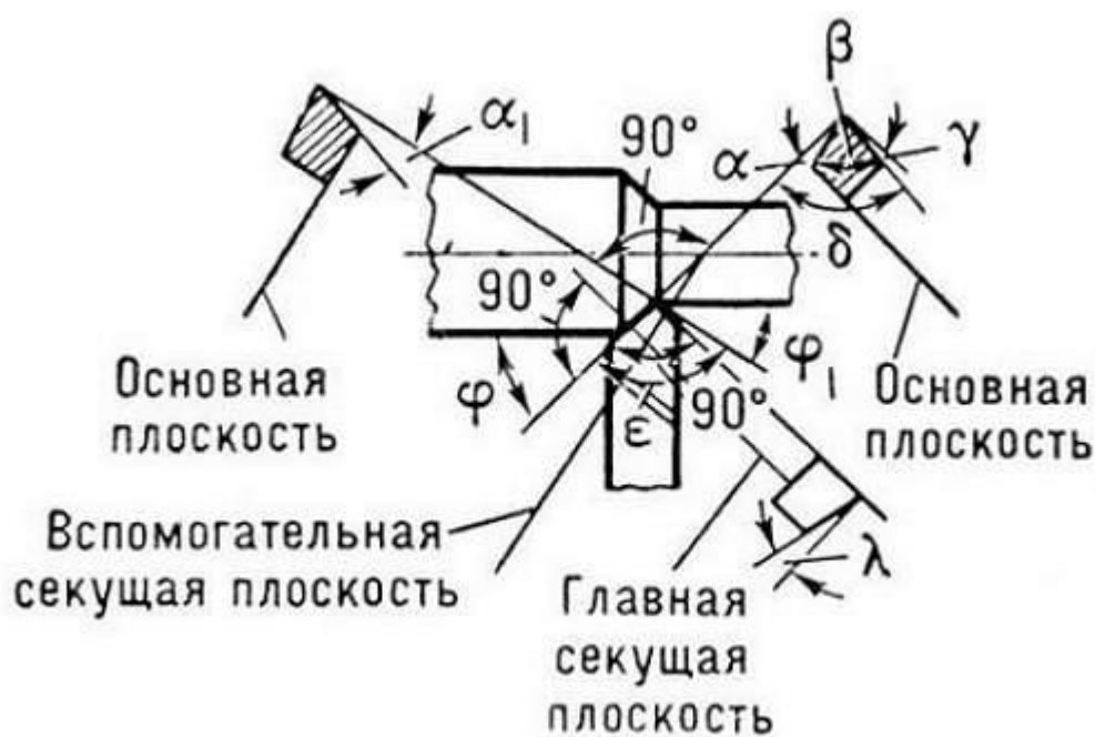
Углы токарного резца
