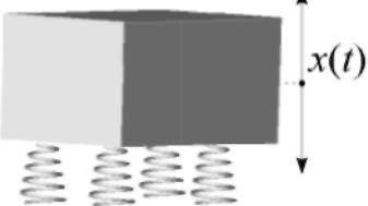
где  $x$  – отклонение блока от исходного положения,  $t$  – время,  $m$  – масса блока,  $d^2x/dt^2$  – ускорение,  $\beta$  – коэффициент трения (в амортизаторах),  $dx/dt$  – скорость движения при колебаниях блока,  $kx$  – слагаемое, отвечающее за сопротивление упругих элементов (пружин),  $k$  – коэффициент жесткости амортизаторов. Суммарная жесткость пружин зависит от деформации  $x$ :  $k = k_0 (1 + ax^2)$ .
