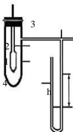
Рис. 1.2. Прибор для измерения поверхностного натяжения по методу Ребиндера:
