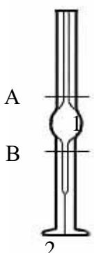
Рис. 1.1. Сталагмометр:
