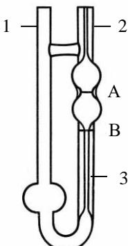
Рис. 1. Капиллярный вискозиметр:
