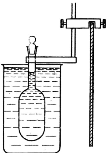
Рисунок 11 – Определение плотности жидкости с помощью пикнометра
