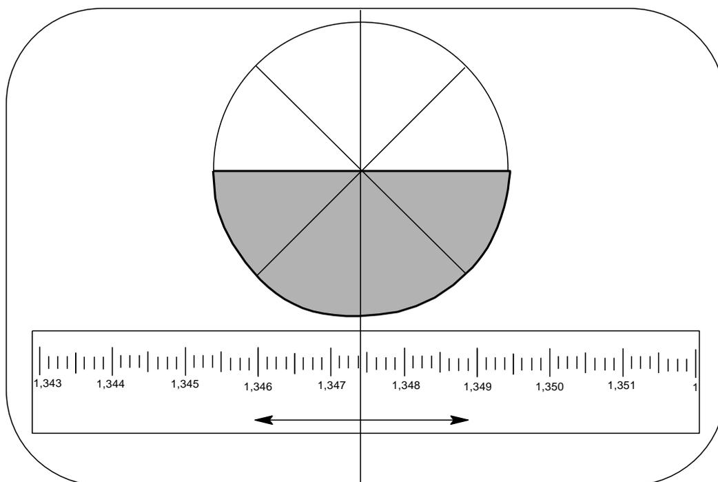
Рисунок 10 – Вид наблюдаемой картинке в окуляре рефрактометра
