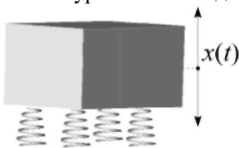
где  $x$  – отклонение блока от исходного положения,  $t$  – время,  $m$  – масса блока,  $d^2x/dt^2$  – ускорение,  $\beta$  – коэффициент трения (в амортизаторах),  $dx/dt$  – скорость движения при колебаниях блока,  $kx$  – слагаемое, отвечающее за сопротивление упругих элементов (пружин),  $k$  – коэффициент жесткости амортизаторов. Суммарная жесткость пружин зависит от деформации  $x$ :  $k = k_0 (1 + ax^2)$ .
