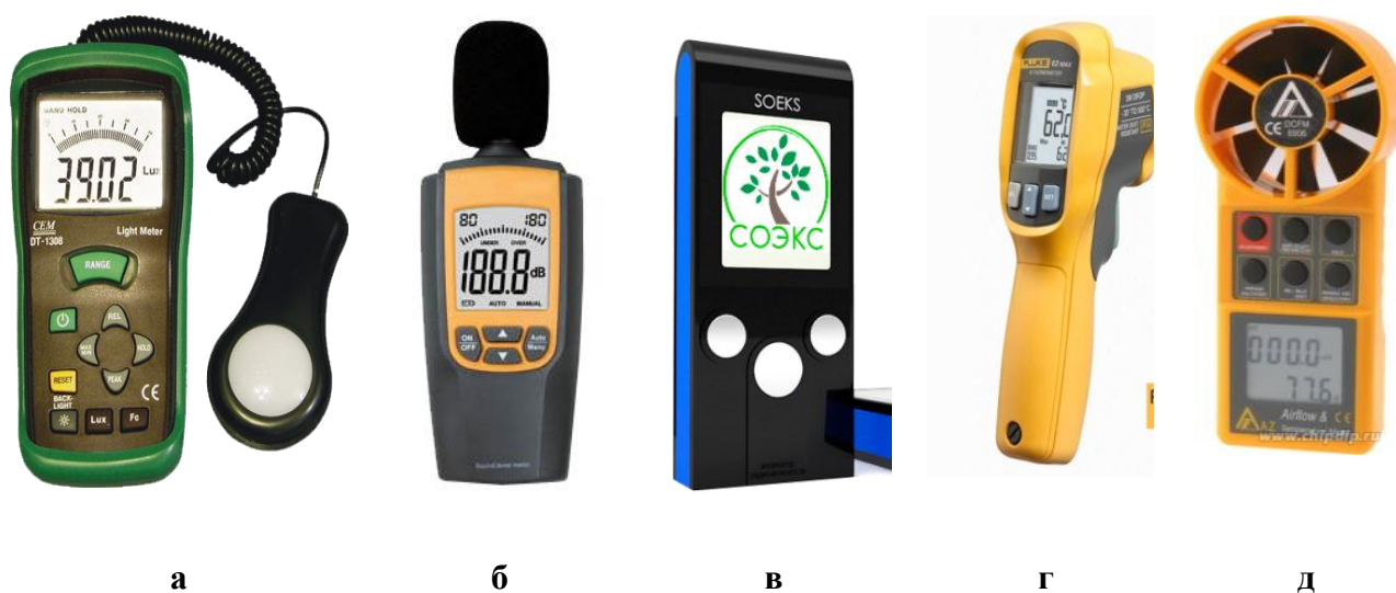
Рисунок 1 - Приборы, используемые для контроля параметров микроклимата
